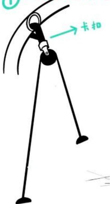
图 3 上肢轮细节：圆形金属卡扣、塑料卡扣、尼龙训练绳
